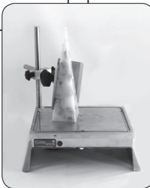
Die Gildewerk Abschmelzstütze ist eine praktische Hilfe um, in Kombination mit der Gildewerk Hotplate, Giesskerzen rechtwinkelig abzuflachen.
